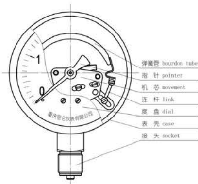
弹簧管压力表 Bourdon tube pressure gauge
